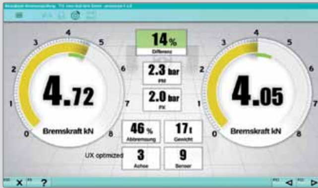
Vom Nutzer einstellbare grafische Oberfläche: Skalendarstellung als Messuhr oder Säulendiagramm
